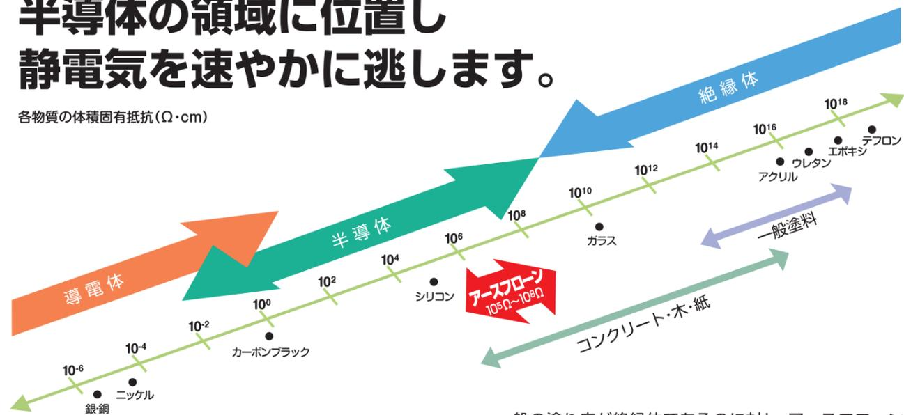
一般の塗り床が絶縁体であるのに対し、アースフローンは、半導体の領域に位置し、静電気の帯電を防止します。アースフローンの表面電気抵抗値は $10^5 \sim 10^8 \Omega$ と低く、労働安全衛生総合研究所技術指針をクリアしています。
